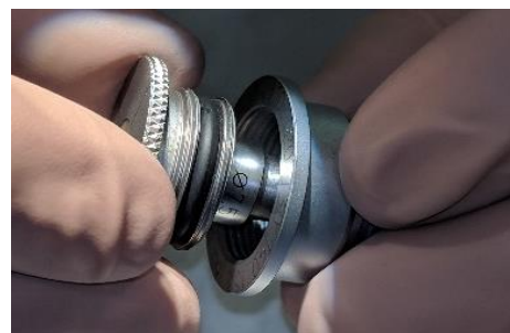
Abbildung 7: Trepankern wird in Trepanations-Hülse geschraubt
