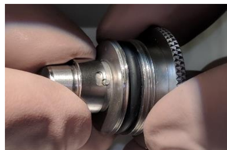
Abbildung 6: Trepan wird mit dem Trepankern verbunden
