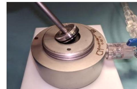
Abbildung 1: CTS-Zentralpilz wird mit dem T-Schraubendreher eingesetzt
