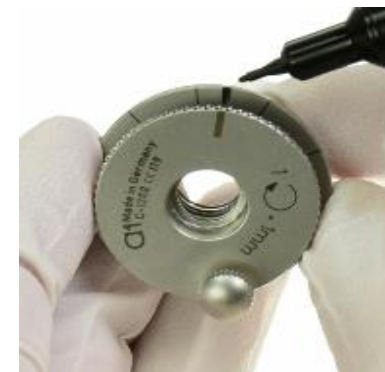
Abbildung 8: Position des Schnittbeginns wird markiert
