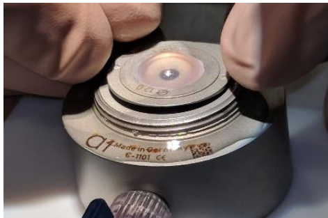
Abbildung 3: Fixierplatte wird aufgelegt
