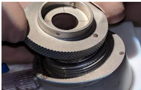
Abbildung 4: CTS Spannschraube wird aufgelegt
