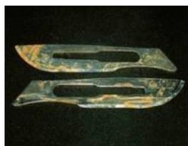
Fissuration par corrosion sous contrainte
