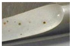
Corrosion par piqûre
