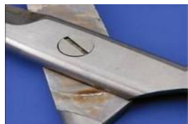
Corrosion de contact
