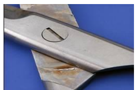
Corrosione per attrito
