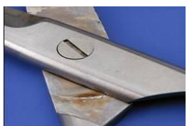
Corrosie door fretten
