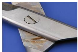
Corrosão por atrito
