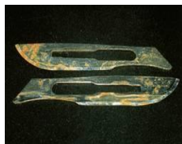
Corrosão à superfície
