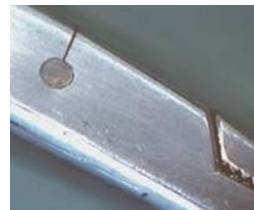
Corrosão sob tensão
